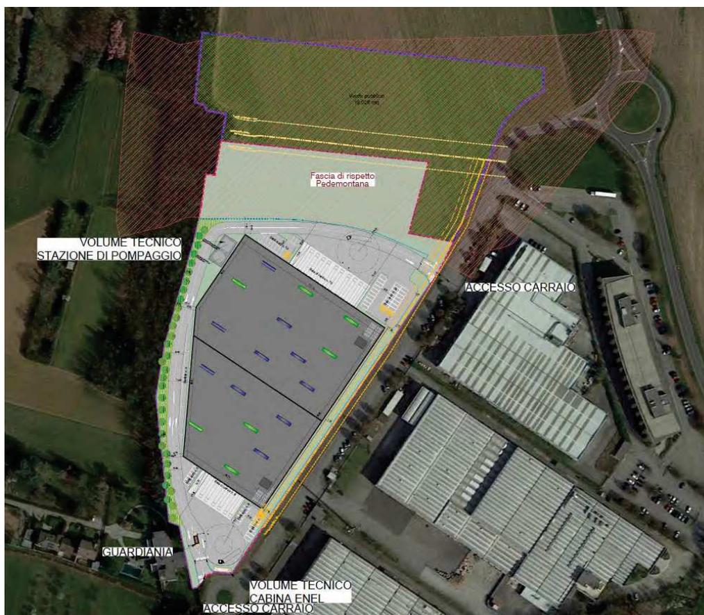
L'intervento di progetto prevede la costruzione di un magazzino avente destinazione d'uso logistica. Trattasi di immobile in elementi prefabbricati con copertura piana in bac-acier suddivisa in due comparti:
