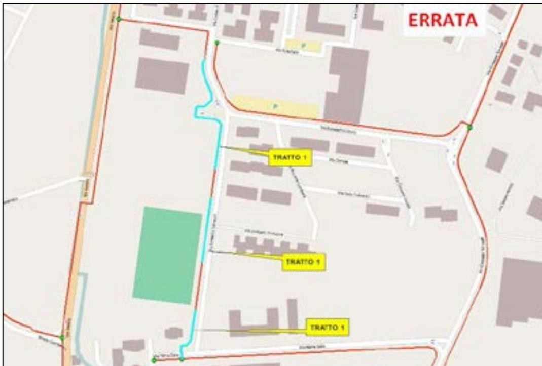
FIGURA 3 - In figura viene evidenziato con il colore azzurro un tratto multipart. Il tratto, costituito da tre parti, è digitalizzato in maniera errata senza continuità fisica.
