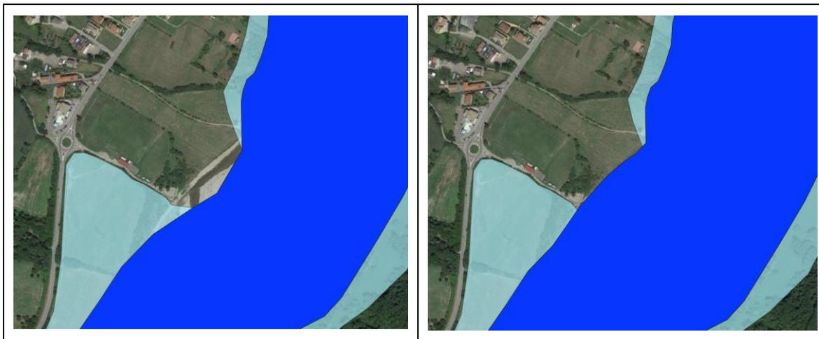
**Fig. 8 – PGRA: a sinistra le aree di pericolosità del PGRA vigente e a destra la proposta di aggiornamento del PGRA per le alluvioni H, M, L in sinistra del fiume Secchia, a seguito arretramento della sponda in località Muraglione**
