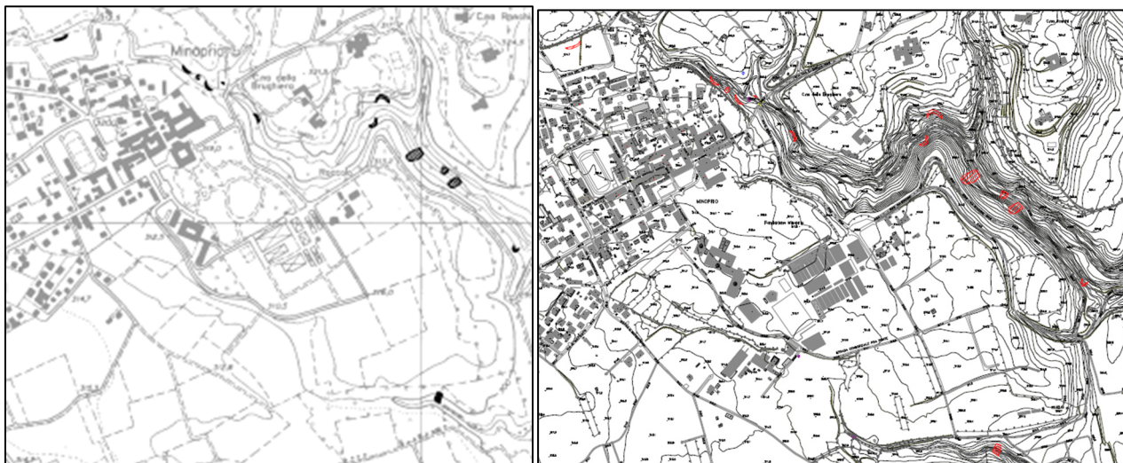
Zona centro- sud: frane attive (Fa PAI) nella zona centrale del territorio comunale - stralci della cartografia PAI vigente (a sinistra) e proposta (a destra)
