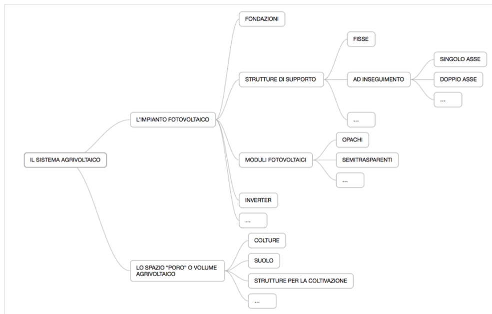
Figura 6 - Le due parti che compongono il sistema agrivoltaico, e cioè il sistema fotovoltaico e lo spazio poro, possono essere scomposte in subsistemi.
