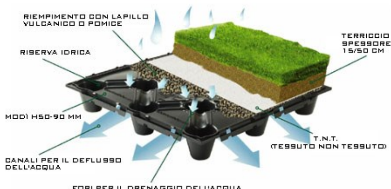
Figura 41 - Esempio pratico di tecnica costruttiva di tetto verde/ verde pensile
