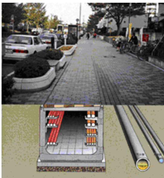
Esempio di strada infrastrutturata con cunicolo tecnologico.
